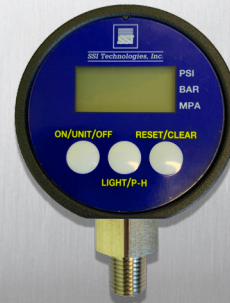
Fill Set Pressure 0-5000 psig 0-350 bar
